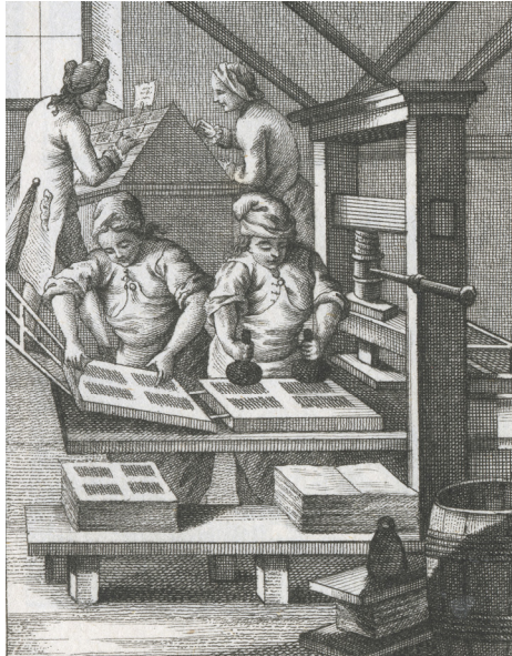
Abb. 21: Im Kupferstich „Der Buchdrucker“ sind einige Arbeitsschritte der Drucklegung thematisiert: vom Setzen der Lettern bis zum Bedrucken der Papierbögen.
